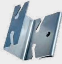
O clip de fixação é um sistema exclusivo da Tessa! Além de ser prático, por ser instalado por baixo da estrutura utilizando apenas um parafuso autobrocante, é flexível, pois não necessita um ponto fixo na terça nem no painel FV para fixação. Ele é eficiente por utilizar apenas duas peças em vez de parafuso, porca, arruelas, Tee de alumínio, entre outros tipos de materiais para fixação.
